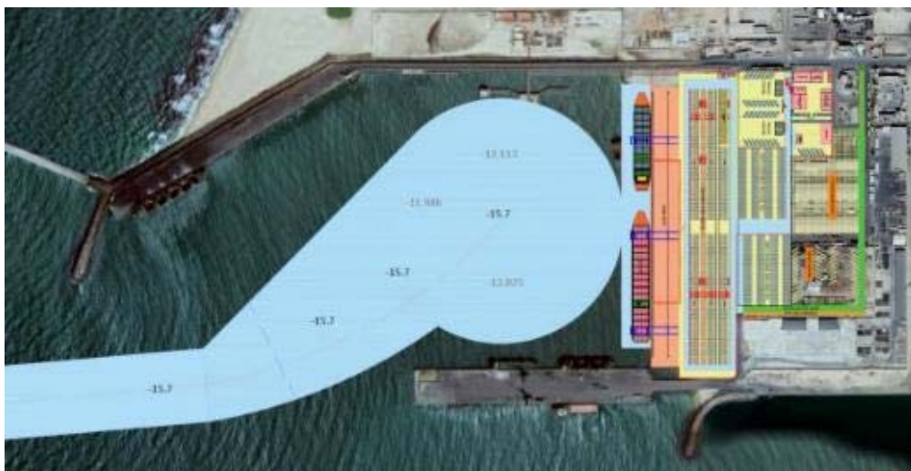
Figure 3-6: Conception préliminaire des composantes de la Phase 1 (Plan No. NCT-EPC-1000-SHEET-1, Novembre 2018, Afcons)
