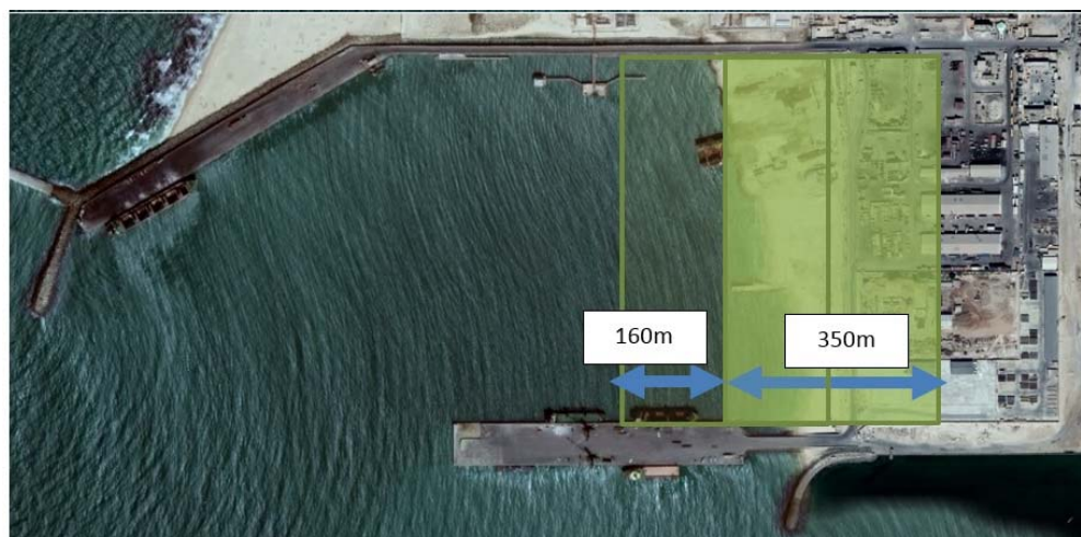
Figure 3-11: Variantes pour la position du nouveau quai
